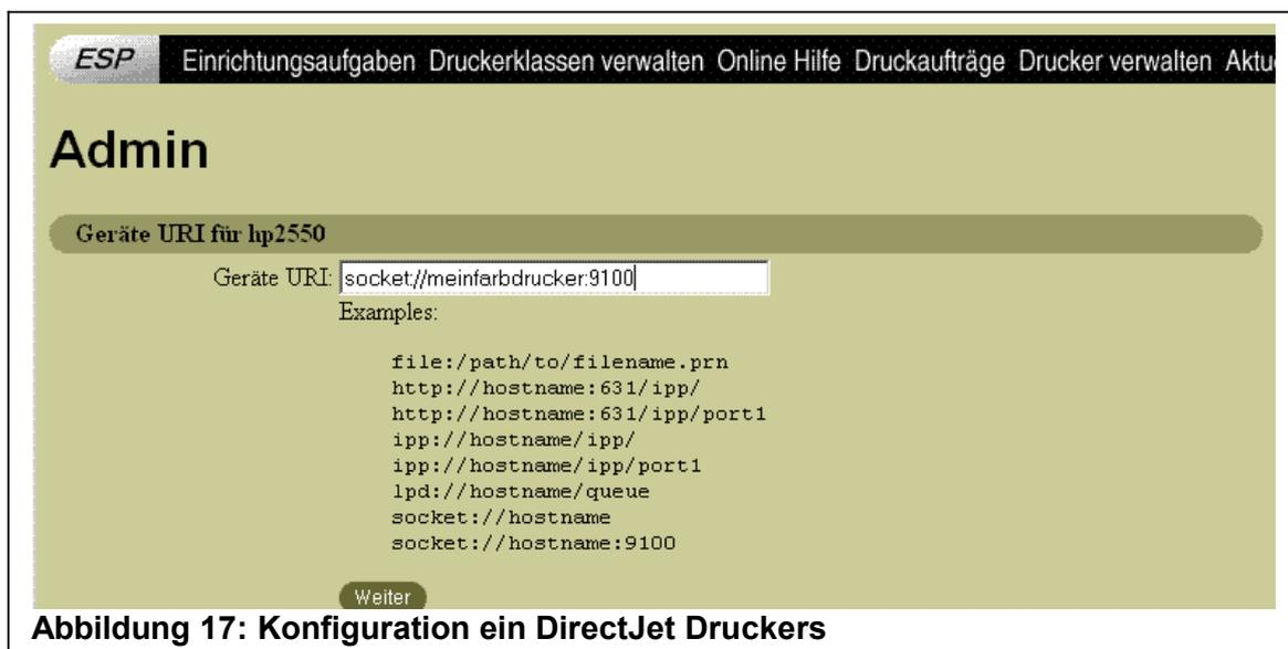
Besondere Netzwerk-Drucker können durch Angabe eines URI-Pfades angeschlossen werden. HP-Drucker verwenden beispielsweise häufig die JetDirect- Schnittstelle, die über den Port 9100/tcp angesprochen wird. Dann kann der Drucker wie im obigen Bild über diese Adresse verbunden werden:
